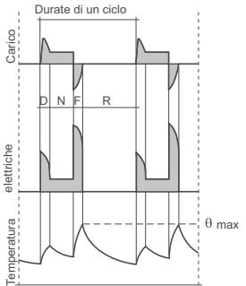
**S6 - Servizio ininterrotto periodico con carico intermittente:** funzionamento del motore secondo cicli identici comprendenti un periodo di funzionamento a carico costante ed un periodo a vuoto senza alcun tempo di riposo.
